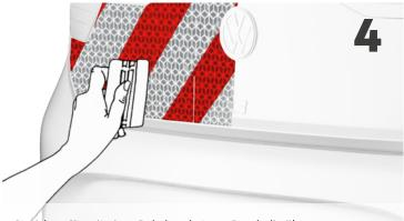
Streichen Sie mit einer Rakel und etwas Druck die überschüssige Flüssigkeit von der Mitte zum Rand hin aus.
