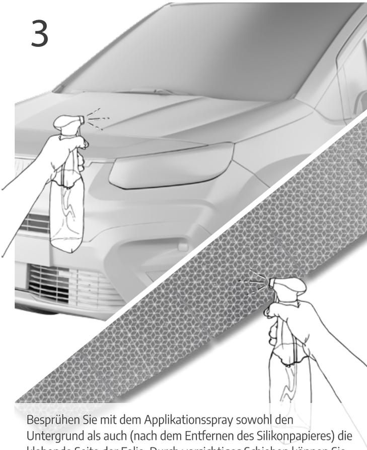
Besprühen Sie mit dem Applikationsspray sowohl den Untergrund als auch (nach dem Entfernen des Silikonpapiers) die klebende Seite der Folie. Durch vorsichtiges Schieben können Sie die Warnmarkierung nun verkleben.
