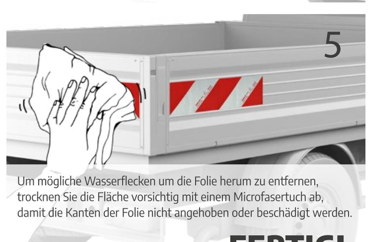
Um mögliche Wasserflecken um die Folie herum zu entfernen, trocknen Sie die Fläche vorsichtig mit einem Microfasertuch ab, damit die Kanten der Folie nicht angehoben oder beschädigt werden.
