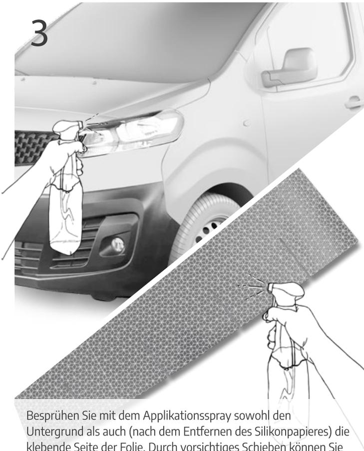
Besprühen Sie mit dem Applikationspray sowohl den Untergrund als auch (nach dem Entfernen des Silikonpapieres) die klebende Seite der Folie. Durch vorsichtiges Schieben können Sie die Warnmarkierung nun verkleben.
