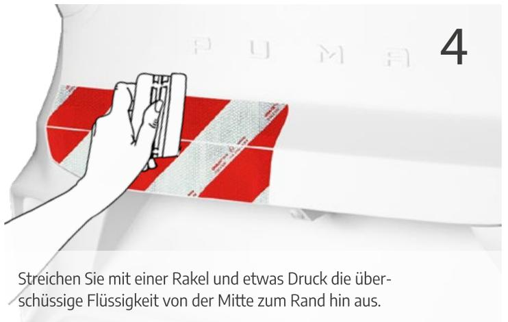
Streichen Sie mit einer Rakel und etwas Druck die überschüssige Flüssigkeit von der Mitte zum Rand hin aus.
