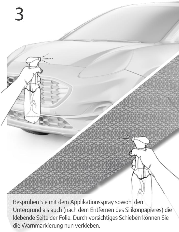
Besprühen Sie mit dem Applikationspray sowohl den Untergrund als auch (nach dem Entfernen des Silikonpapiers) die klebende Seite der Folie. Durch vorsichtiges Schieben können Sie die Warnmarkierung nun verkleben.
