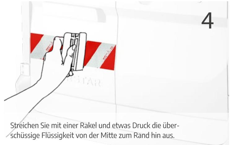
Streichen Sie mit einer Rake und etwas Druck die überschüssige Flüssigkeit von der Mitte zum Rand hin aus.
