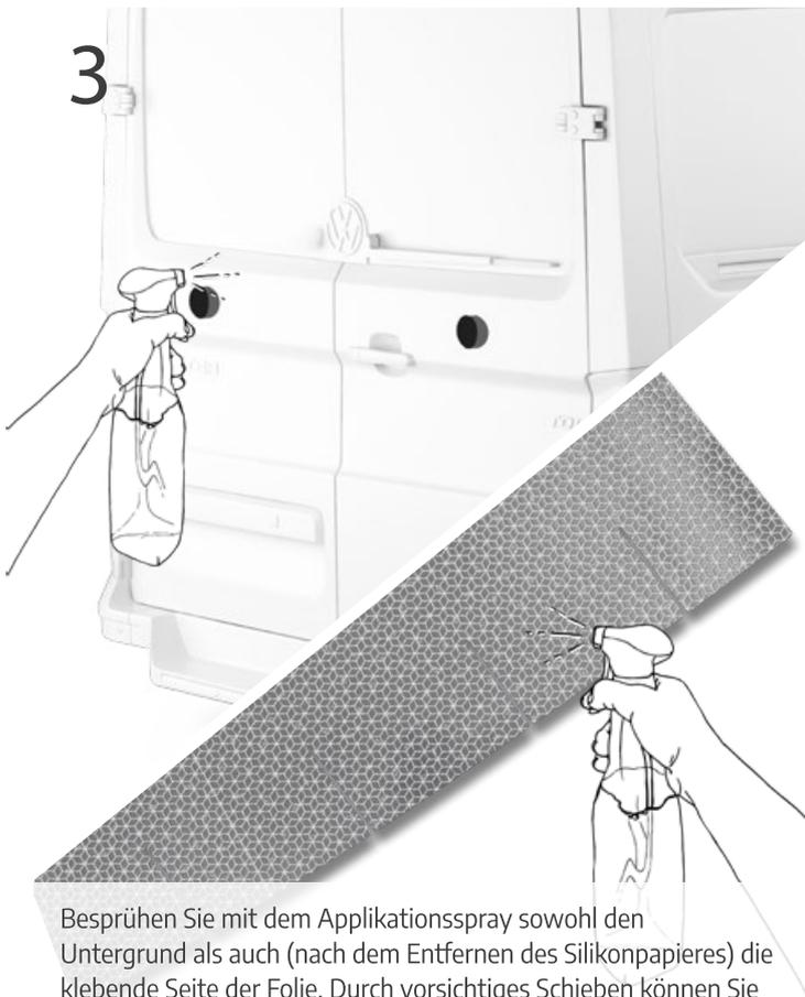
Besprühen Sie mit dem Applikationsspray sowohl den Untergrund als auch (nach dem Entfernen des Silikonpapieres) die klebende Seite der Folie. Durch vorsichtiges Schieben können Sie die Warnmarkierung nun verkleben.
