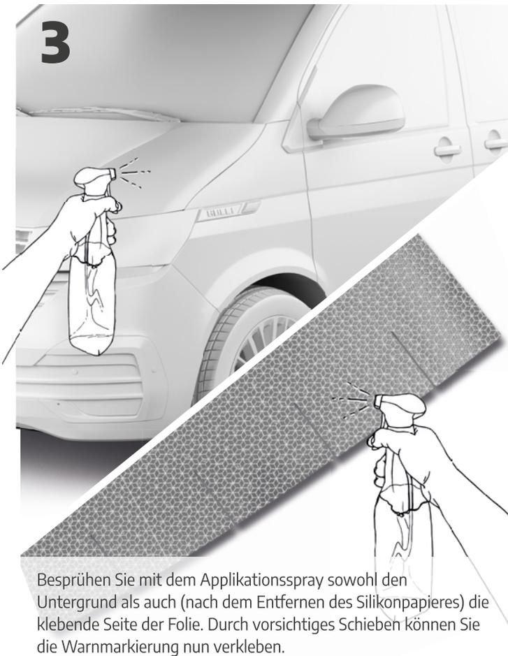
Besprühen Sie mit dem Applikationsspray sowohl den Untergrund als auch (nach dem Entfernen des Silikonpapieres) die klebende Seite der Folie. Durch vorsichtiges Schieben können Sie die Warnmarkierung nun verkleben.
