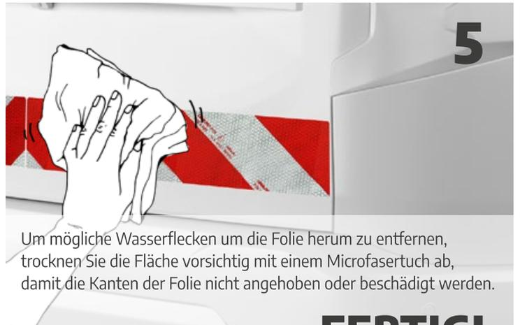
Um mögliche Wasserflecken um die Folie herum zu entfernen, trocknen Sie die Fläche vorsichtig mit einem Microfasertuch ab, damit die Kanten der Folie nicht angehoben oder beschädigt werden.
