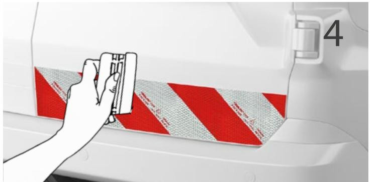
Streichen Sie mit einer Rakel und etwas Druck die überschüssige Flüssigkeit von der Mitte zum Rand hin aus.
