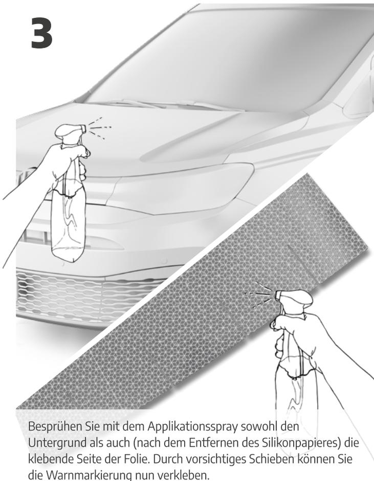
Besprühen Sie mit dem Applikationsspray sowohl den Untergrund als auch (nach dem Entfernen des Silikonpapiers) die klebende Seite der Folie. Durch vorsichtiges Schieben können Sie die Warnmarkierung nun verkleben.
