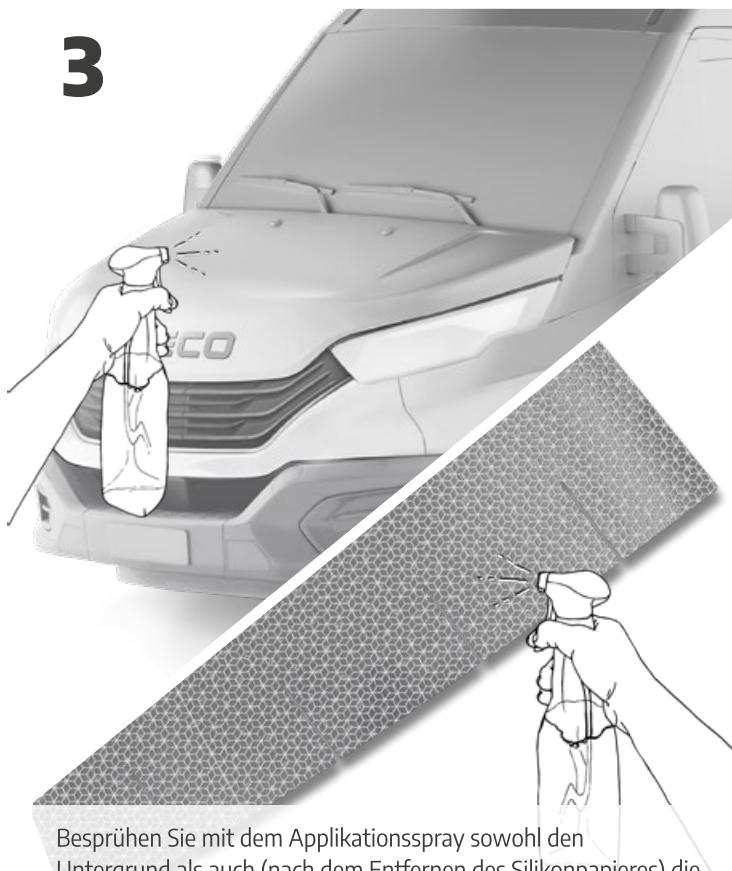
Besprühen Sie mit dem Applikationsspray sowohl den Untergrund als auch (nach dem Entfernen des Silikonpapiere) die klebende Seite der Folie. Durch vorsichtiges Schieben können Sie die Warnmarkierung nun verkleben.
