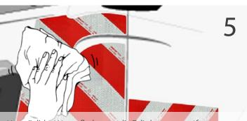
Um mögliche Wasserflecken um die Folie herum zu entfernen, trocknen Sie die Fläche vorsichtig mit einem Microfasertuch ab, damit die Kanten der Folie nicht angehoben oder beschädigt werden.
