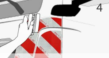
Streichen Sie mit einer Rakel und etwas Druck die überschüssi<mark>ge Flüssig</mark>keit von der Mitte zum Rand hin aus.
