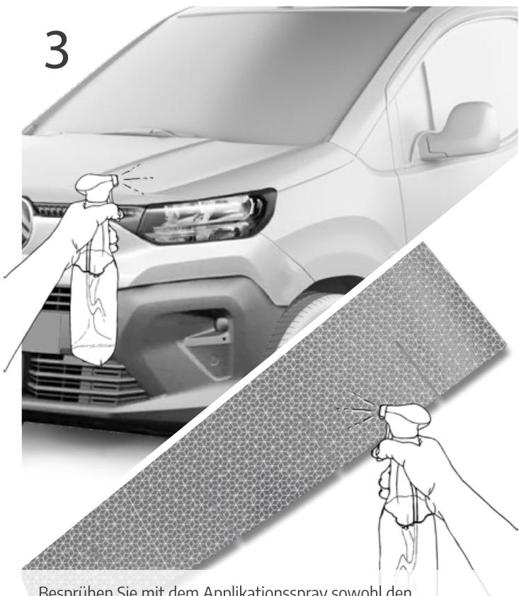
Besprühen Sie mit dem Applikationsspray sowohl den Untergrund als auch (nach dem Entfernen des Silikonpapiers) die klebende Seite der Folie. Durch vorsichtiges Schieben können Sie die Warnmarkierung nun verkleben.
